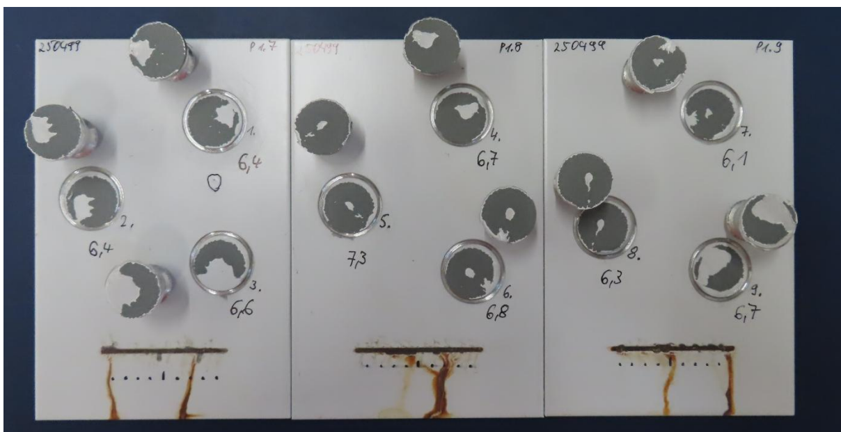
Bild 5: P1.7-P1.9 – Stempelabrisse und Ritzauswertung
